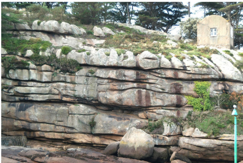
Figure 4. Exemple de fractures (subhorizontales) au sein de l'horizon fracturé d'un granite. La maison située en haut à droite a une hauteur maximale d'environ 3 m. Ploumanac'h, Côtes d'Armor, France. [© R. Wyns]
