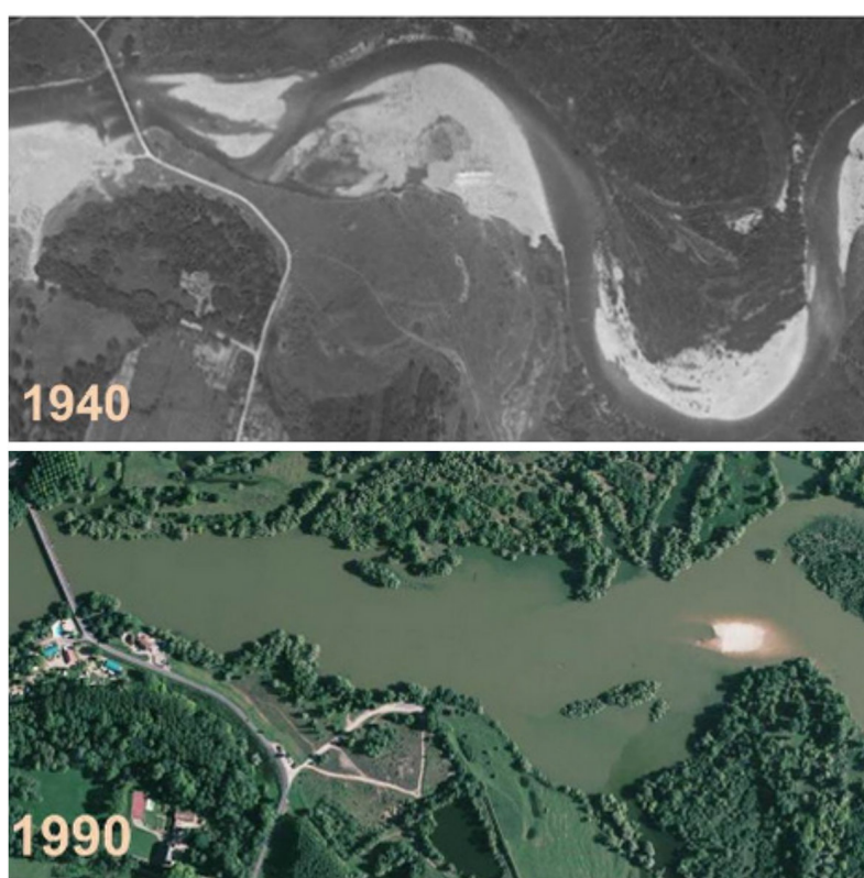
Figure 7. Le Doubs au niveau de Fretterans : en 1940, il forme une belle rivière sinueuse avec des bancs de galets soulignant un transport solide actif. Dans les années 1990, après plusieurs années d'une intense activité extractive, son lit est devenu une vaste zone lacustre interrompant pour plusieurs décennies le transit des sédiments [Source : © Géoportail, IGN]
