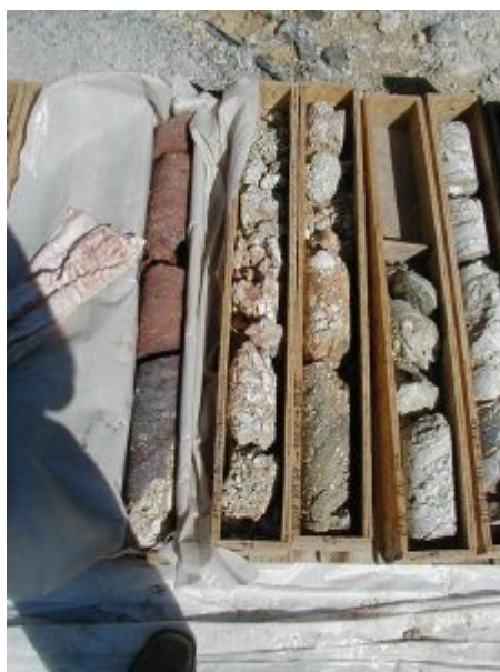
Figure 1. Exemple de carottes rocheuses. Elles sont plus ou moins cylindriques, selon l'altérabilité de la roche, mais aussi selon la technique de carottage. Par exemple pour les matériaux très déformables, on utilise un double carottier dont seule la partie externe tourne avec le train de tige, la partie centrale restant elle libre de toute rotation. [Source : Photo F.H. Cornet]
