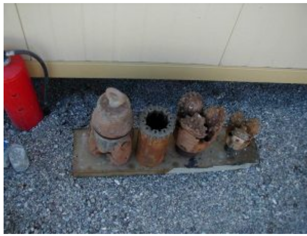
Figure 2. Exemples d'outil de forage. On remarque sur la gauche le carottier utilisé pour produire les carottes de la figure 6. Sur sa droite, deux exemples de trépan à molettes. [Source : Photo F.H. Cornet]
