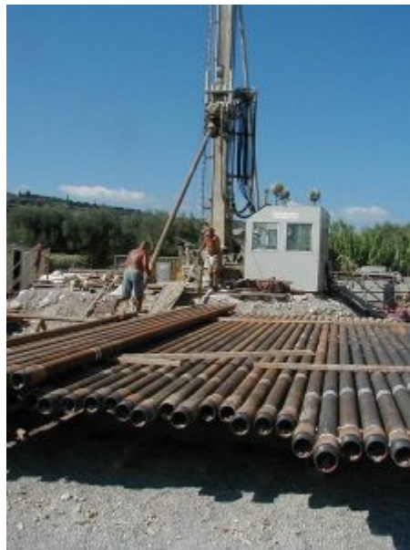
Figure 3. Exemple d'un petit appareil de forage pour atteindre jusqu'à 800 m de profondeur. Les tiges de forage sont ici disposées devant l'appareil. Pour les plus grandes profondeurs, les tiges sont tenues verticales à côté du mas de forage et sont manipulées automatiquement. [Source : Photo F.H. Cornet]
