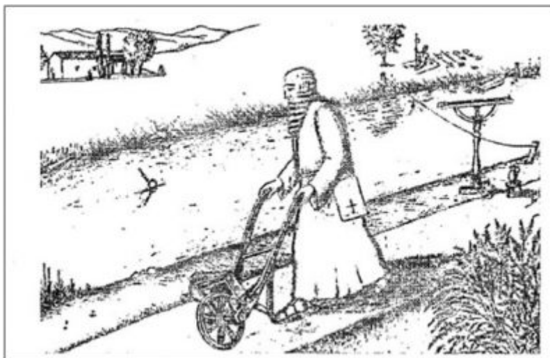
Figure 1. Mesure de vitesse de surface par Léonard de Vinci [Source : reconstitution par Arthur H. Frazier]
