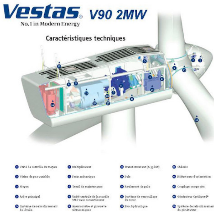
Figure 5. Vue éclatée de la nacelle VESTAS® - V90 – 2 MW [Source : © VESTAS - droits réservés]
