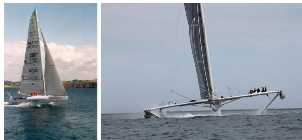
Figure 10. Voilier hydroptère réalisé par Alain Thébault pour le navigateur Eric Tabarly à partir d'une coque de trimaran Tornado de 18,24 m de long. Les jambes minces qui relient les coques latérales à l'aile sont réalisées en titane, la hauteur du mat, lui aussi en titane, est de 27 m. Cet hydroptère a battu le record de vitesse sur une distance de 500 m en septembre 2009 : 51,36 nœuds, soit 95,3 km/h, avec une vitesse de pointe de 55,5 nœuds, soit 103 km/h. [Source : (photo gauche) Par Ludovic Peron (Photographie personnelle) [CC BY-SA 2.5 ( http://creativecommons.org/licenses/by-sa/2.5 )], via Wikimedia Commons. (photo droite) Par Thomas Lesage (Own work) [CC BY-SA 3.0 ( http://creativecommons.org/licenses/by-sa/3.0 )], via Wikimedia Commons]
