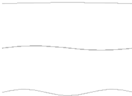
Figure 6. Oscillation d'une corde vibrante entre deux points fixes : mode fondamental et deux premiers harmoniques. [Source : By Christophe Dang Ngoc Chan (cdang) (Own work) [GFDL ( http://www.gnu.org/copyleft/fdl.html ) or CC-BY-SA-3.0 ( http://creativecommons.org/licenses/by-sa/3.0/ )], via Wikimedia Commons]
