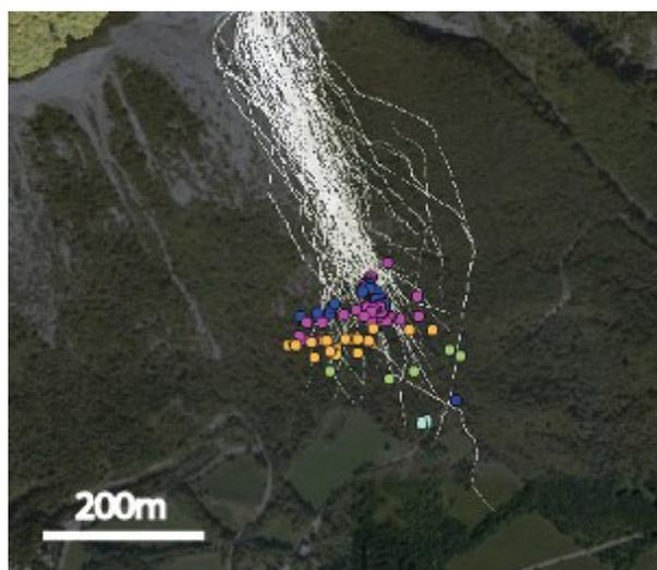
*Figure 7. Exemple de simulation d'un éboulement : les traces blanches représentent les trajectoires simulées des blocs ; les points colorés représentent les blocs éboulés observés sur le versant. (logiciel utilisé : Rockyfor3D)*
