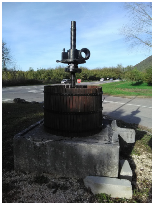
Figure 6. Pressoir à raisin : dans ce cas, l'expulsion du fluide se fait radialement : on parle de consolidation radiale. [Source : © Etienne Flavigny]
