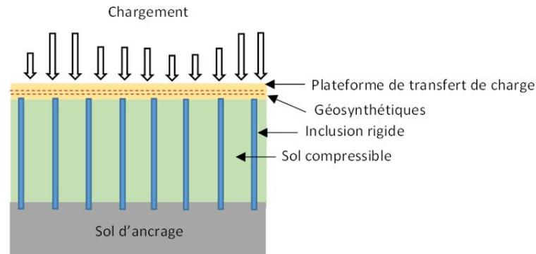
Figure 4. Principe de fonctionnement des inclusions rigides.
