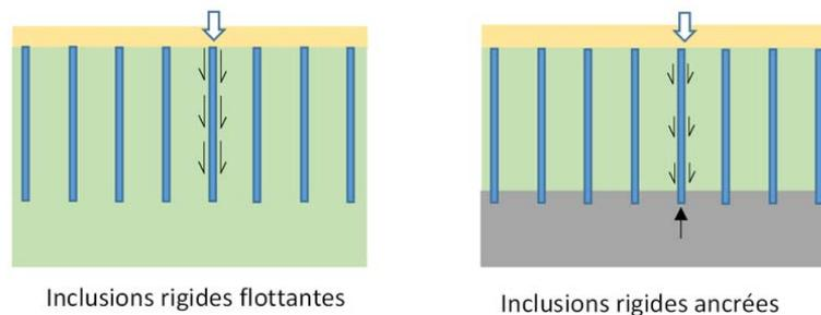
Figure 3. Système d'inclusions rigides flottantes et ancrées.
