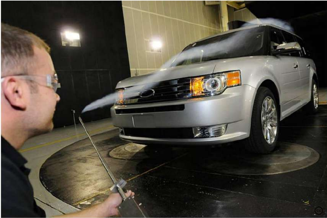
图 11. 在风洞中，使用烟雾来可视化绕汽车的气流流动，并测试降低型面阻力的可能性。 [图片来源:美国福特汽车公司( http://creativecommons.org/licenses/by/2.0 )或者维基百科共享( http://creativecommons.org/licenses/by/2.0 )]
