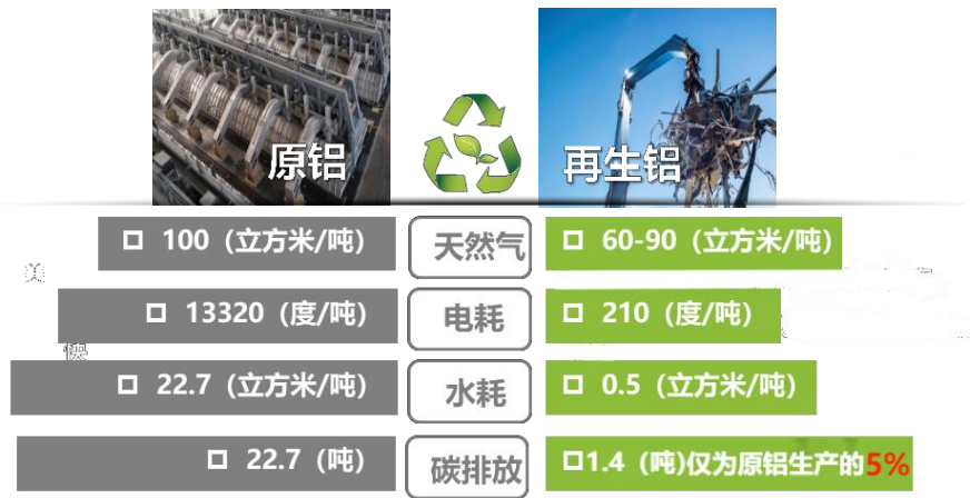
图 3、原铝与再生铝资源消耗对比 [图片来源：由中国科学院大学 EPM 实验室提供并授权使用]
