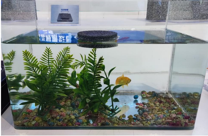
图12、 能漂浮在水面上的泡沫铝材料 [图片来源：由魏桥集团子公司魏桥轻量化提供并授权使用]
