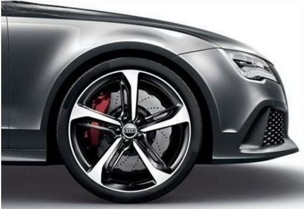
图8、 铸造成型的汽车轮毂 [来源： 奥迪 RS 7 Dynamic 版官图 https://news.16888.com/a/2014/0416/363857.html ]
