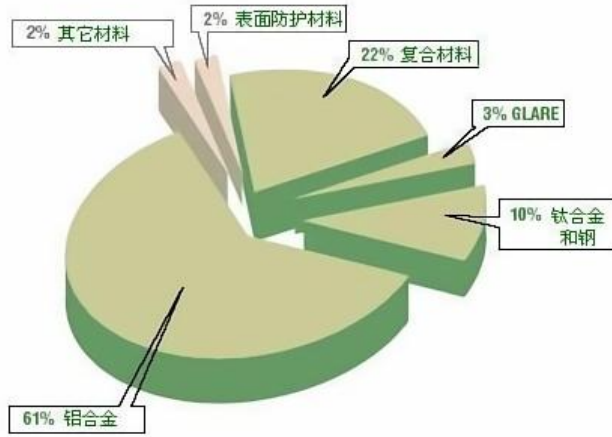
图 9、A380 飞机的主要材料应用情况 [数据来源:
