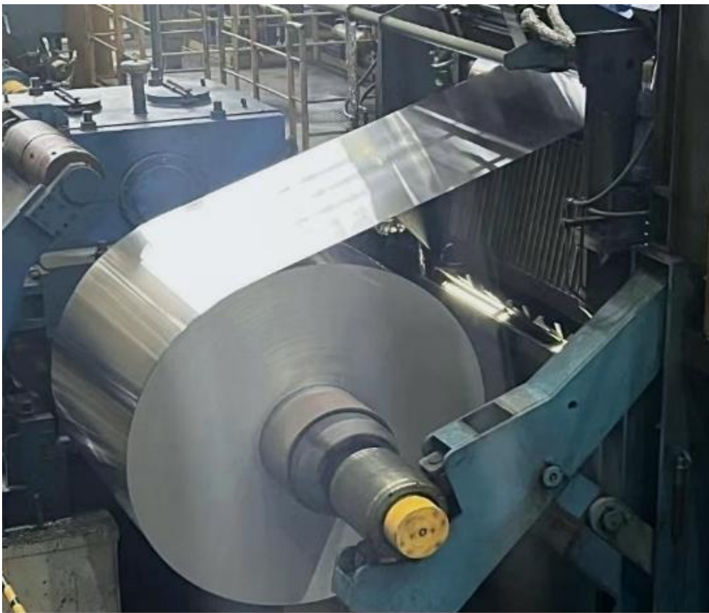
图2、经过多道轧制生产的铝箔 [图片来源：由魏桥集团提供并授权使用]
