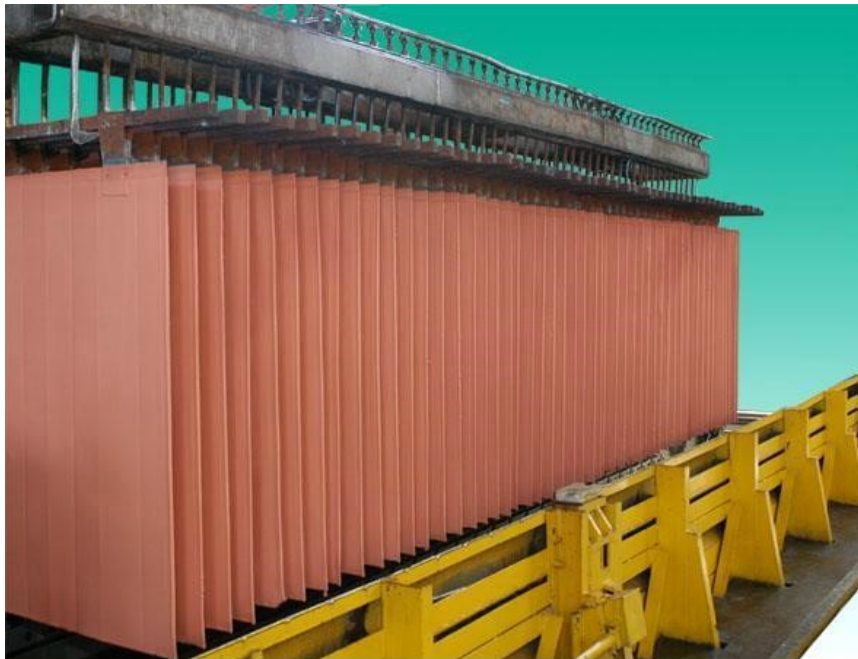
图 8 作为阴极获得的高纯铜板 [图片来源: China.makepolo.com]
