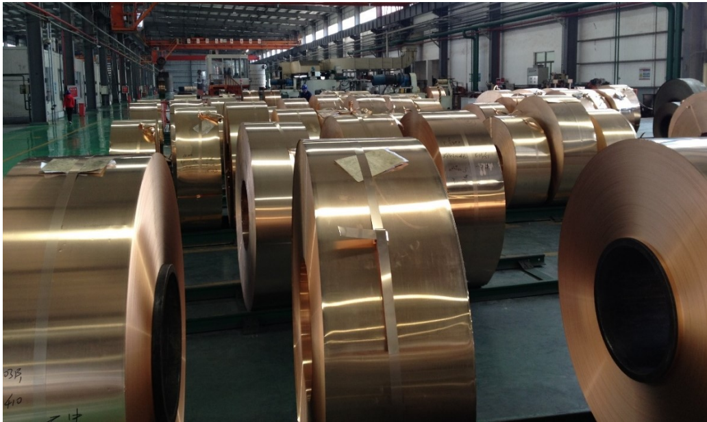
图15 轧制的引线框架铜合金带材[图片来源：作者拍摄]
