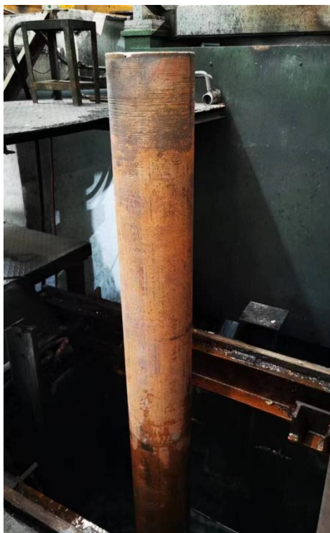
图10 铜铬锆合金圆坯垂直半连续铸造照片[图片来源：作者拍摄于宁波金田铜业（集团）股份有限公司，授权使用]
