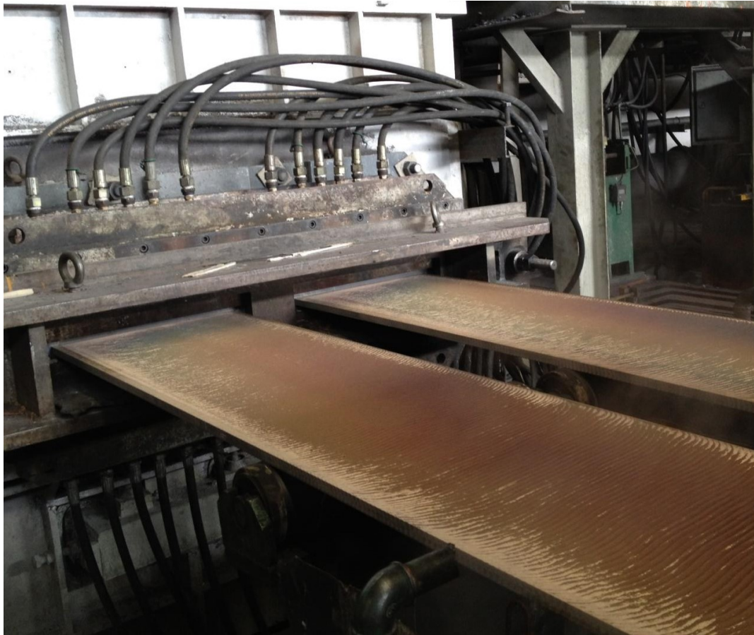
图9 锡磷青铜板带坯的水平连续铸造照片[图片来源：作者拍摄]
